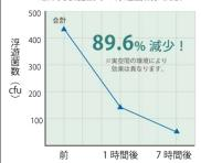
屋内でおこる空気の自然対流 を利用して空気中の浮遊菌を 減少。また、長寿命高性能紫 外線ランプを使用しており、 24時間連続使用した場合、 約7か月に1度のランプ交換 を除いて日常の保守点検など は不要です。
