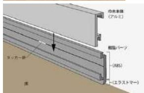
凹凸ある床面との調整も、樹脂ベースと組み合わせることで、あらゆる床に対応できるように設計されています。ぜひご活用ください。
