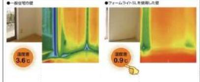
一般住宅の壁は、わずかな隙間から冷気が室内に侵入しているため温度差が大きいのにに対し、フォームライト SL は冷気の侵入がなく、温度差が小さい! 結露も防げます!!
