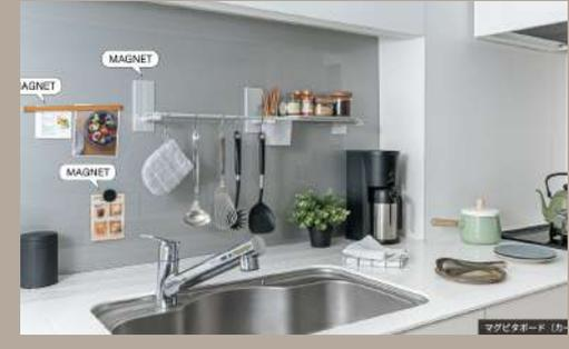
マグネットが付く不燃建材「マグピタボード」のパール系は、衛生的・耐久性に優れており、お掃除もカンタン♪丸のこでカット可能なので施工現場での急なサイズ変更にも対応できます。
